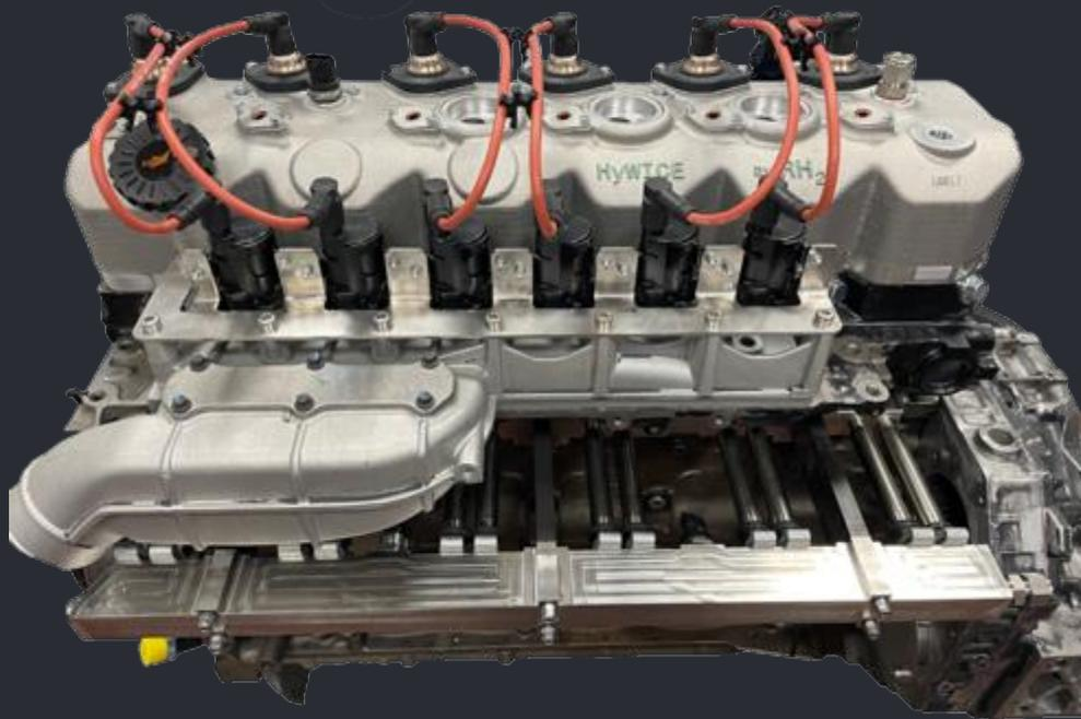
« Grâce à un mécanisme d'entretoise mécatronique, RH2 remplace le carburant diesel par **une double Injection directe d'hydrogène et d'eau** ».
